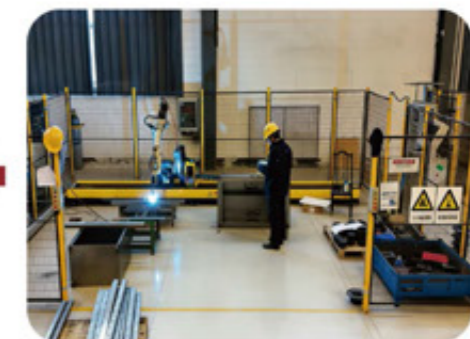
机器人焊接自动化生产线
