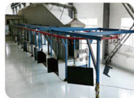
JQ1612/6喷粉涂装生产线
