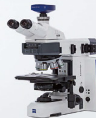
德国蔡司正置材料显微镜
