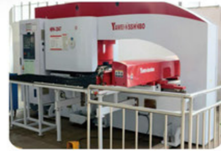
江苏亚威HPH-3047数控转塔冲床
