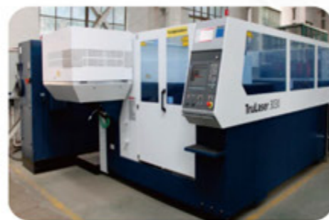
德国TRUMPF-Trulaser3030激光切割机
