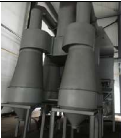
抛丸废气治理设备 (旋风除尘器)
